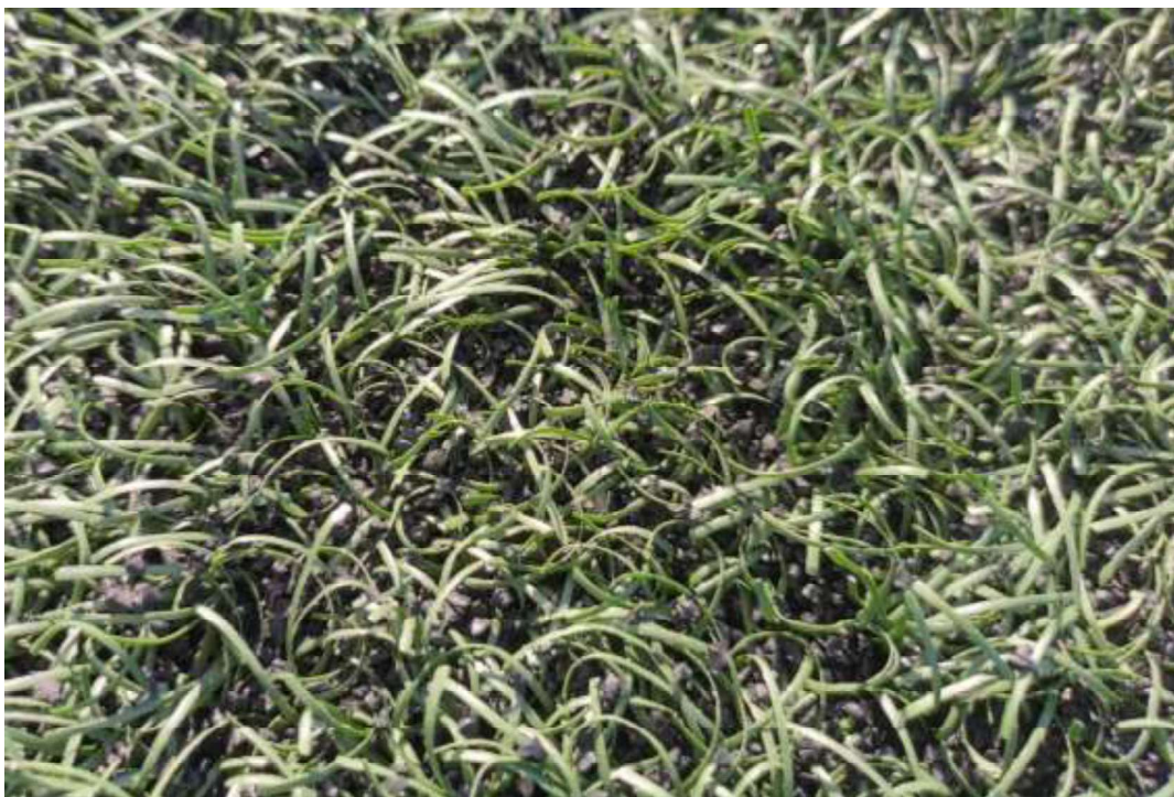
Bilde 1: Bilde av østre målfelt. Fiberen er noe oppsplittet og bøyer seg over fyllmaterialene
