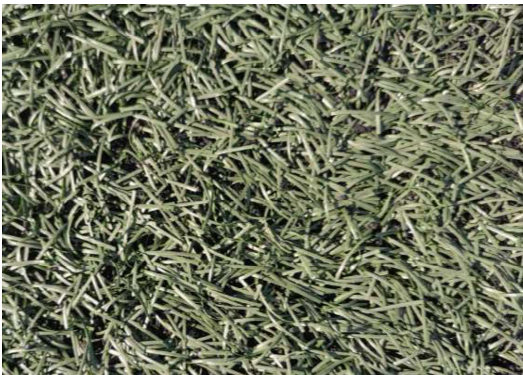
Bilde 3: Fiberen har lagt seg overfyllmaterialet over store deler av banen. Dette skyldes lang fiber (60 mm) og liten fyllhøyde (ca 30 mm) noe som gir 30 mm fri høyde med fiber og liten støtte
